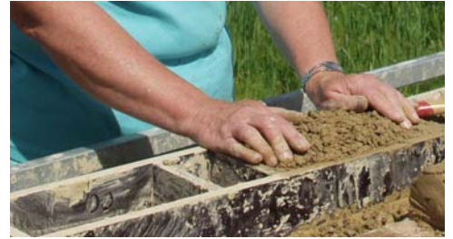
Fylling av leire i steinforme.
