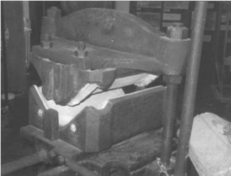
Nockpannor och falstegel pressades i en gjutjärnsform i en gipsinlägg.
